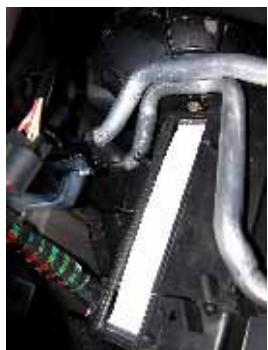
**(PL)** Ostrożnie usuwać zabrudzony filtr, następnie zamontować nowy oraz wykonać powyższe czynności w kolejności odwrotnej
