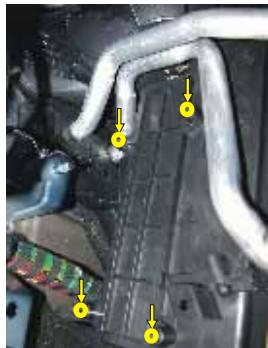
**(PL)** Odkręcić wkręty pokrywy filtra, usunąć pokrywę
